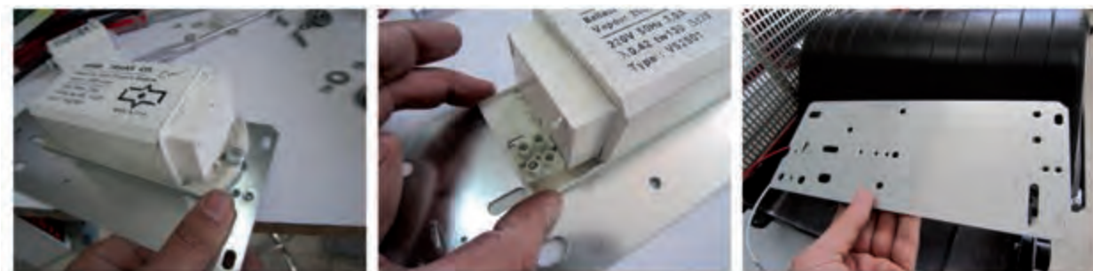
شکل ۲-۳۹ - نحوه نصب بالاست در نورافکن
