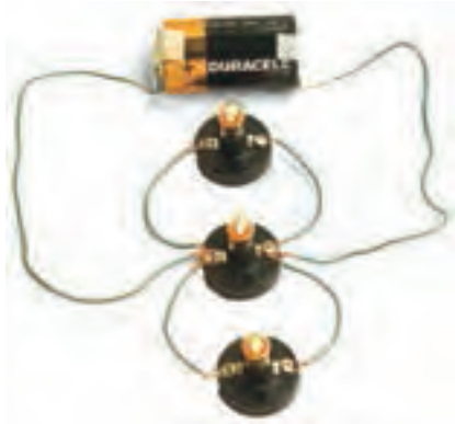
شکل ۵-۵۳- اتصال سه لامپ به صورت موازی
