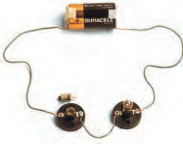
شکل ۵-۲۱- قطع لامپ موجب قطع شدن مدار سری می‌شود.
