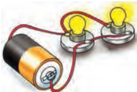
شکل ۵-۶۳ - اتصال دو لامپ به صورت موازی
