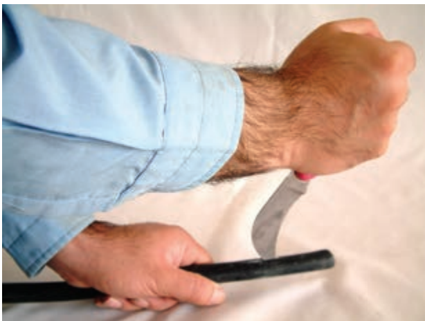
شکل ۳۳-۵- طریقه‌ی صحیح روکش برداری کابل
