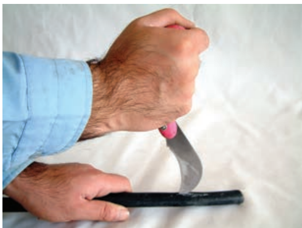
شکل ۳۲-۵ - روکش برداری غلط
