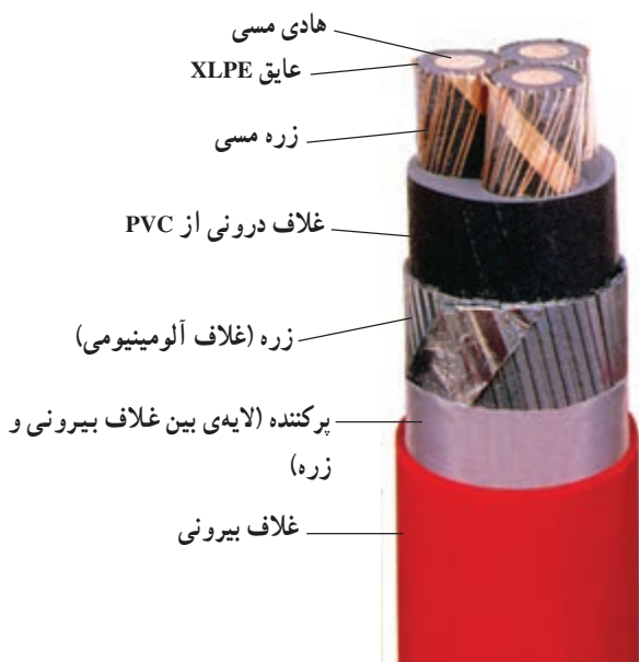
شکل ۵-۷- کابل با غلاف آلومینیومی
