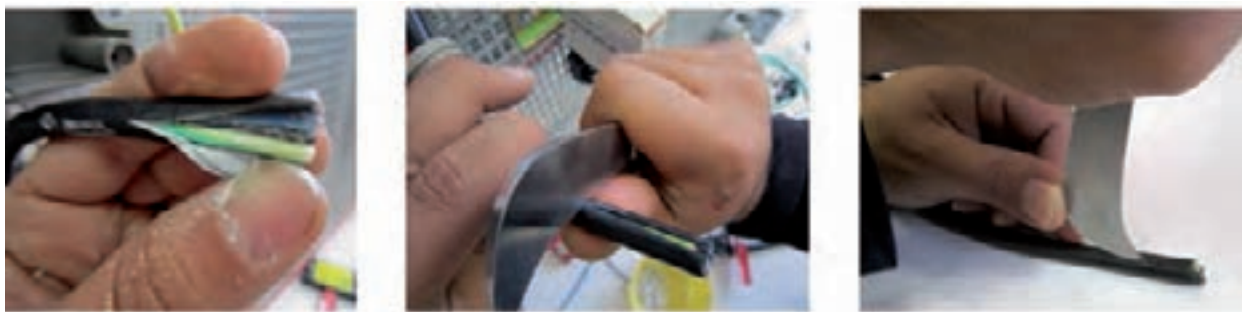
شکل ۲-۲۲ - بریدن و لخت کردن کابل
