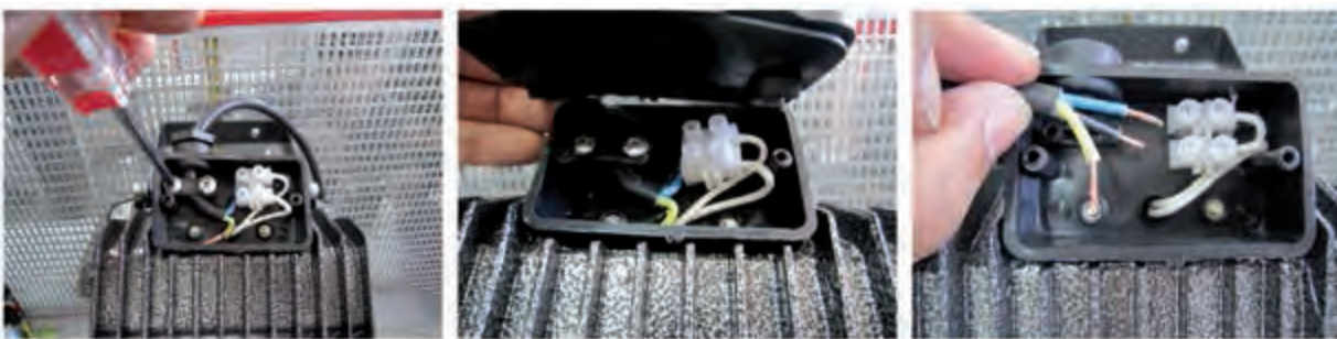
شکل ۲-۲۵ - سیم کشی در جعبه اتصالات
