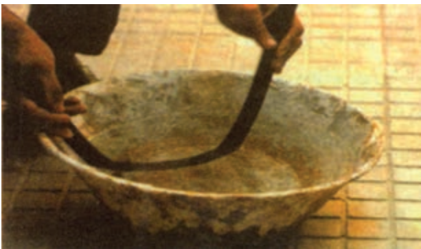
شکل ۴-۴۵- سرد کردن لوله پس از خم کاری
