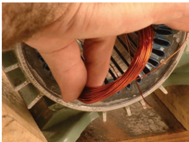
شکل ۱۵-۲ قراردادن بازوی شماره یک در شیار شماره ۱
