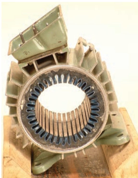
شکل ۲-۱۳- انتخاب شیار شروع و مسیر کلاف‌گذاری
