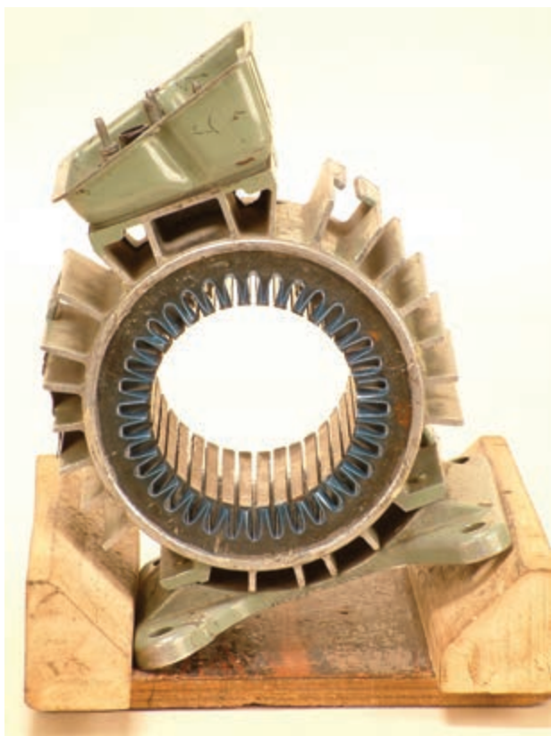
شکل ۲۹-۲-ب - انتخاب شیار شروع سیم‌بندی
