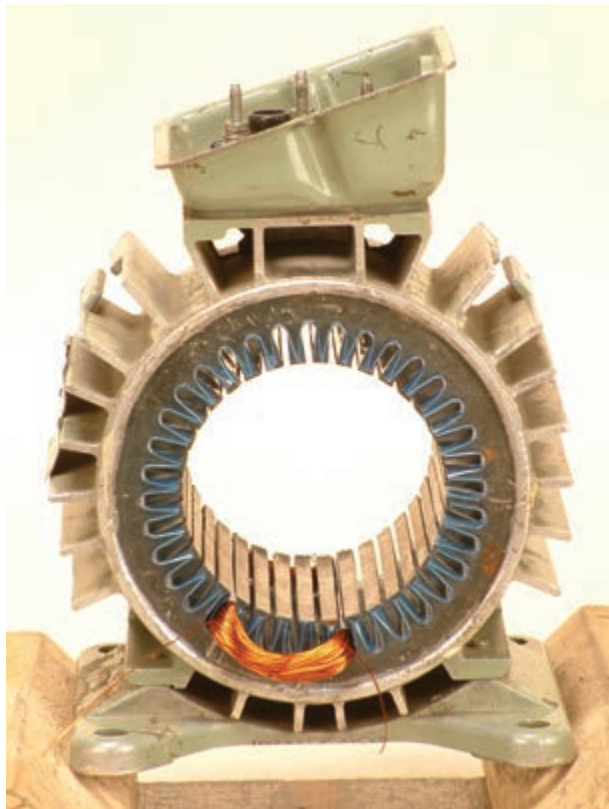
شکل ۲۹-۲-ج - قراردادن کلاف شماره ۱
