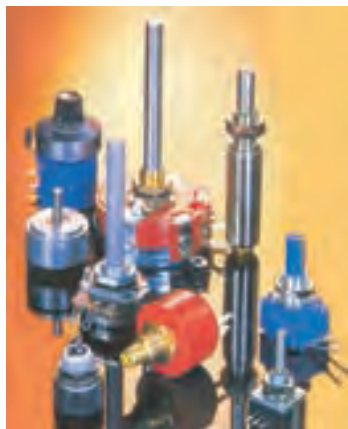
ب - مقدار مقاومت با چرخاندن ولوم به کمک دست تغییر می کند.
