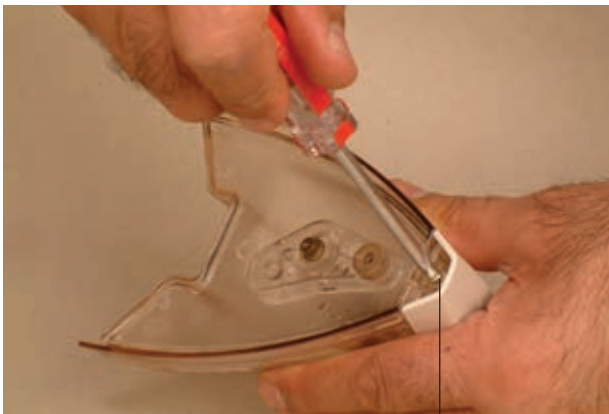
پیچ محکم کننده‌ی قاب پلاستیکی به بدنه‌ی مخزن
