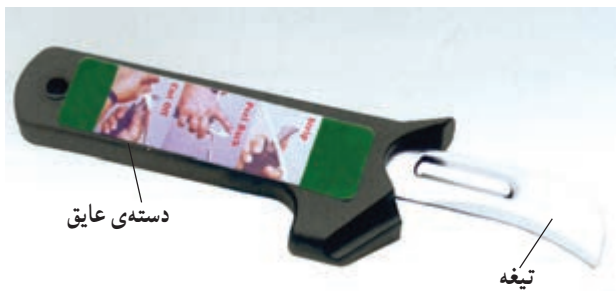
شکل ۱۴-۱- چاقوی کابل‌بری با دسته‌ی حفاظدار
