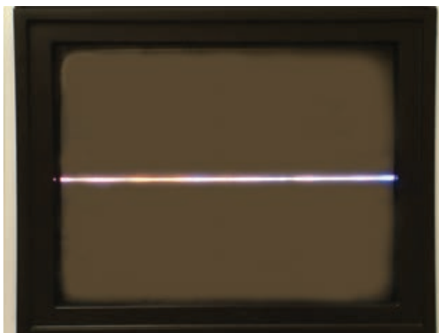
شکل ۲-۹۳- تصویر روی صفحه تلویزیون وقتی D۴۲۱ قطع است.
