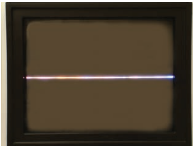
شکل ۲-۹۱- تغذیه آی سی تقویت خروجی عمودی وجود ندارد.
