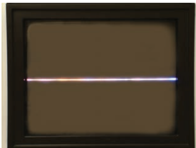
شکل ۲-۸۶- اسیلاتور عمودی از کار افتاده است.
