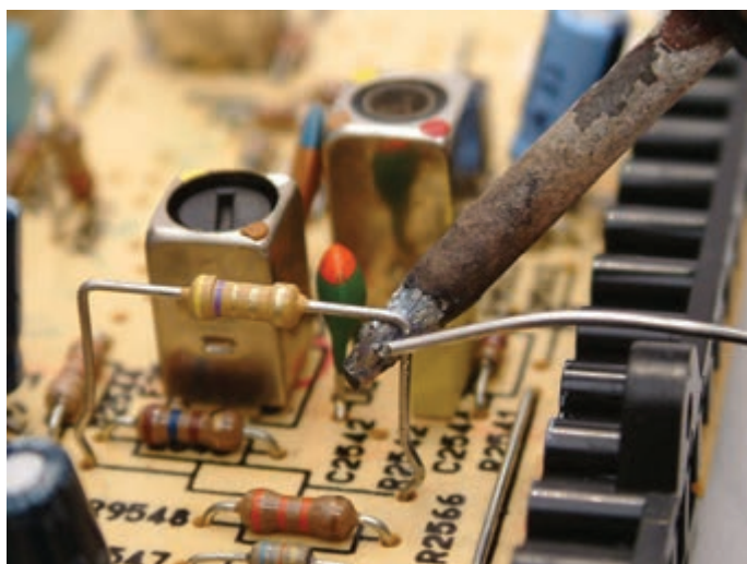
شکل ۳۰-۲ لحیم کاری مجدد پایه قطعه شده قطع پس از اتمام کار
