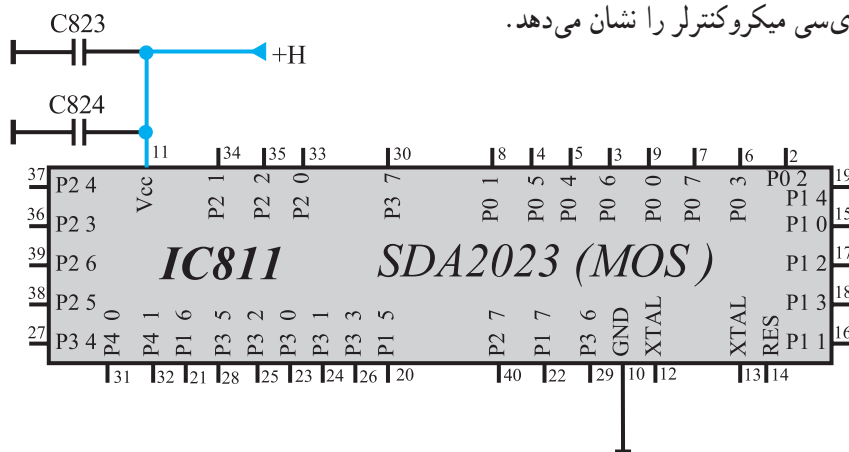
شکل ۲-۵۰ پایه ۱۱ آی سی میکروکنترلر
