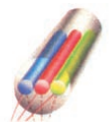
شکل ۹۳-۱- سیستم تولید اشعه In Line
