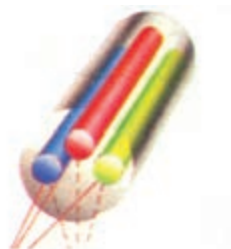
شکل ۹۴-۱- سیستم تولید اشعه \Delta
