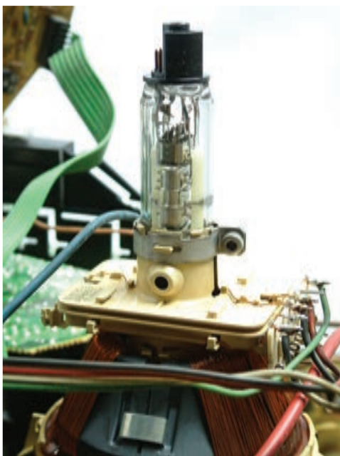
شکل ۱-۷۱-الف - شکل لامپ تصویر و پایه‌های آن
