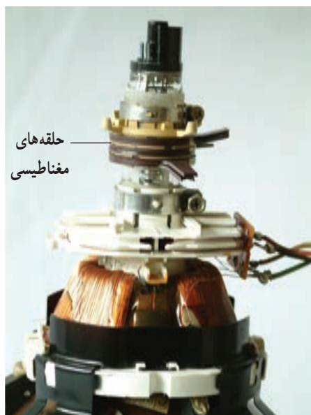
شکل ۹۸-۱ حلقه‌های مغناطیسی روی گردن لامپ
