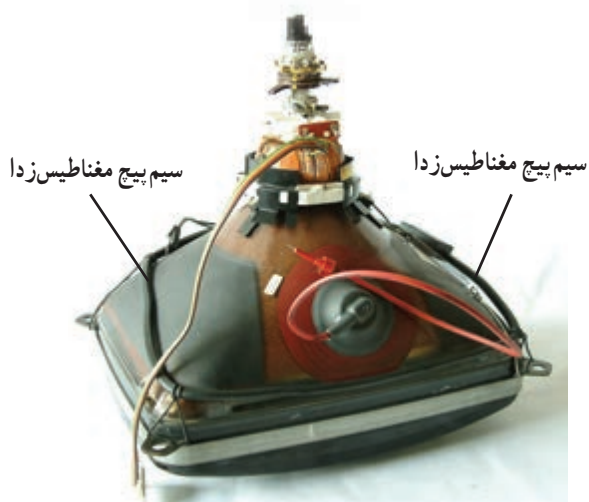
شکل ۱۰۵-۱- مدار سیستم دگوسینگ در تلویزیون گروندیک
