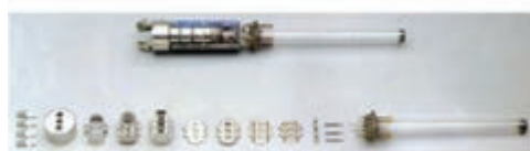
شکل ۱-۷ اجزای یک تفنگ الکترونی
