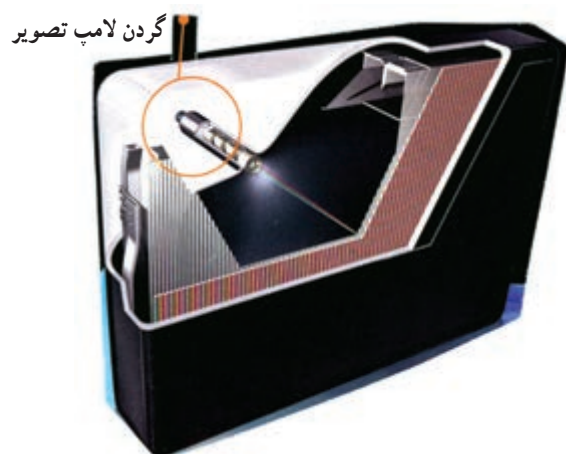
شکل ۱-۳- لامپ تصویر رنگی و گردن آن
