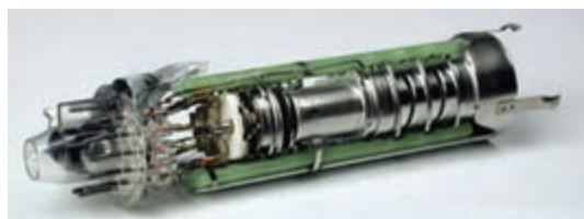
شکل ۱-۵ تفنگ الکترونی تلویزیون رنگی
