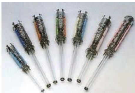
شکل ۱-۴ انواع تفنگ الکترونی
