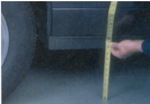
شکل ۳-۲۰۱- ارتفاع سیستم تعلیق (خودرو)
