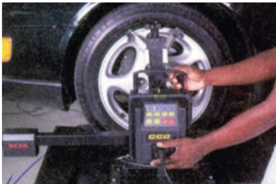
شکل ۳-۲۲۰ - نصب مجموعه حسگر دستگاه اندازه‌گیر رایانه‌ای
