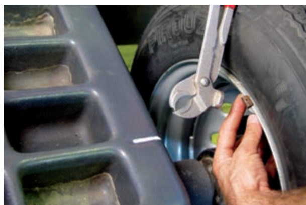
شکل ۲۳۹-۳- نصب وزنه روی قسمت داخلی رینگ
