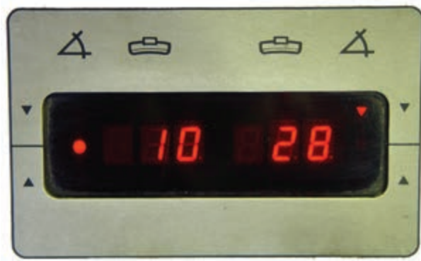
شکل ۲۳۷-۳- تعیین وزنه مورد نیاز در صفحه نشان‌دهنده
