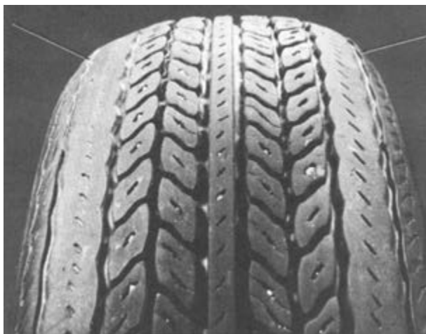
شکل ۲۱۴-۳- سایش در اثر رانندگی غلط (پیچیدن تند)
