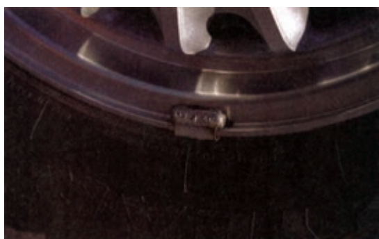
شکل ۳-۲۳۱- نصب وزنه روی رینگ
