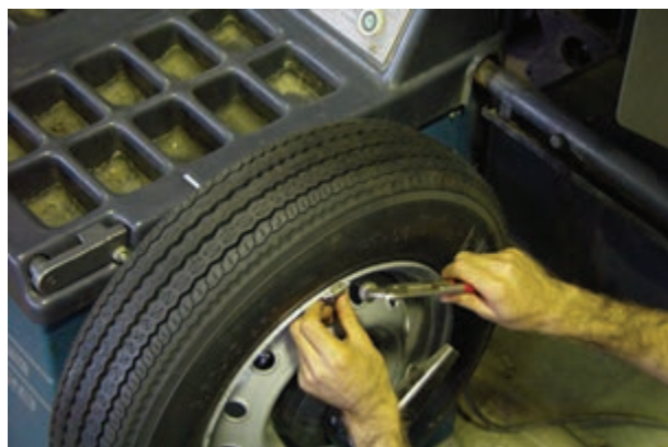
شکل ۲۳۸-۳- نصب وزنه روی قسمت بیرونی رینگ
