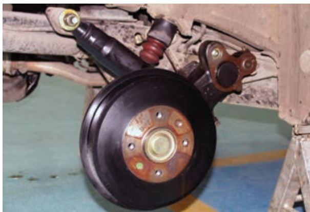
شکل ۱۷۷-۳- نصب کمک فنر
