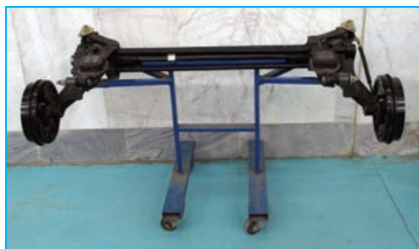
شکل ۱۵۹-۳- مجموعه تعلیق عقب
