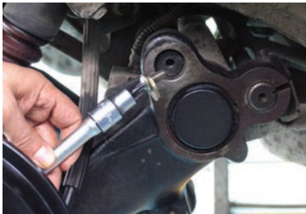
شکل ۱۷۶-۳- نصب واشر فشاری و بیج‌های انتهای میله‌ها
