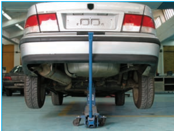
شکل ۳-۱۵۶- تنظیم ارتفاع و کنترل رام لوله‌ای
