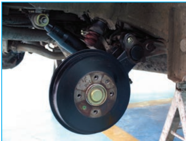
شکل ۱۸۳-۳- نصب ژامبون و متعلقات چرخ عقب
