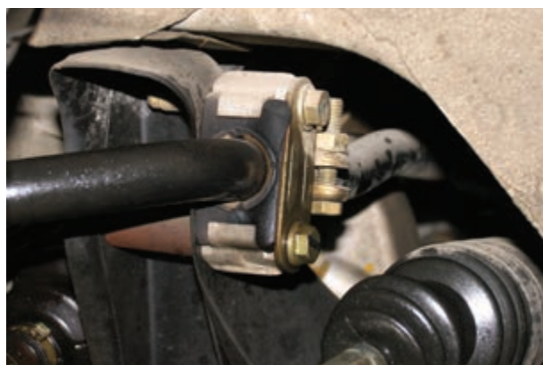
شکل ۱۳۲-۳- نصب بست‌های میل موج گیر بلند
