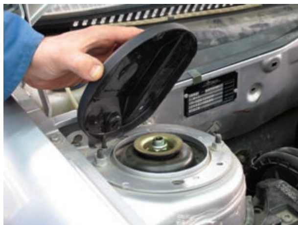
شکل ۳-۱۰۳ برداشتن پوشش بالای تکیه‌گاه کمک فنر
