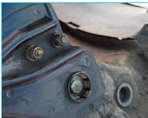
شکل ۳-۱۲۲- باز کردن پیچ‌های طبق
