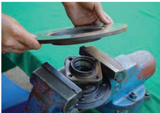
شکل ۳-۹۸- جدا کردن دیسک ترمز از تویی چرخ
