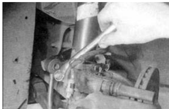
شکل ۱۱۸-۳- بستن پیچ نگه‌دارنده کمک فنر
