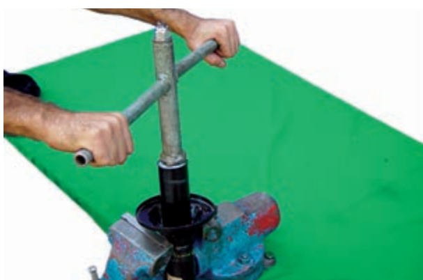
شکل ۳-۹۱- باز کردن مهره نگه‌دارنده کمک فنر
