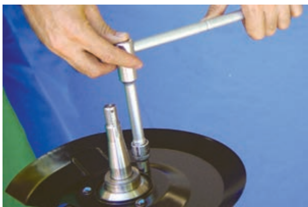
شکل ۳-۹۶- باز کردن صفحه پشت توپی چرخ
