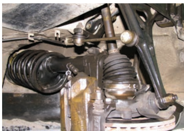
شکل ۱۳۱-۳- نصب میل موج گیر کوتاه
