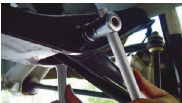
شکل ۳-۸۳- باز کردن طبق از رام
