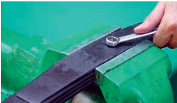
شکل ۳-۶۸- باز کردن پیچ مرکز فنرهای شمش
