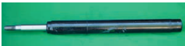
شکل ۳-۹۲- کمک فنر قابل تعویض
