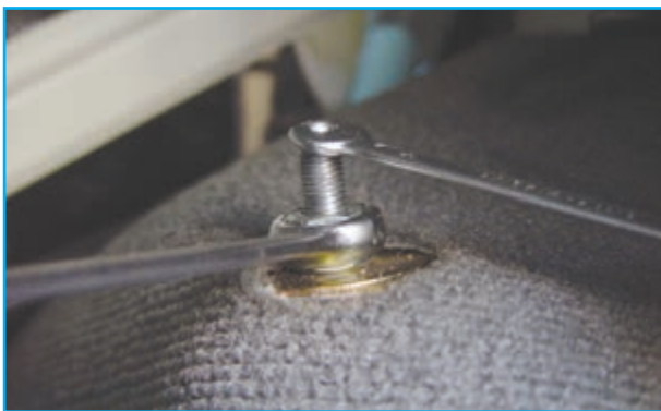
شکل ۳-۶۳- باز کردن مهره اتصال بالای کمک فنر
