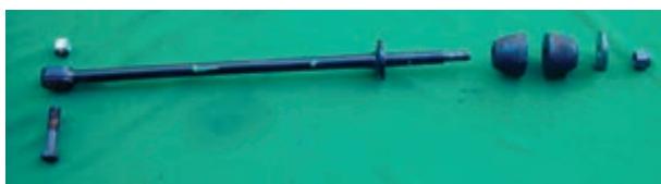
شکل ۳-۸۴- اجزای میل تعادل
