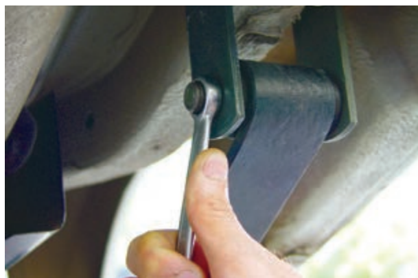
شکل ۳-۶۵- باز کردن مهره‌های گوشواره فنر شمش
