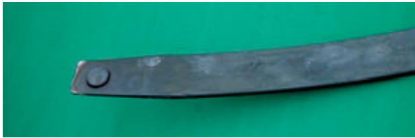
شکل ۷۰-۳- لاستیک‌های محافظ انتهایی لایه‌های فنر شمش
