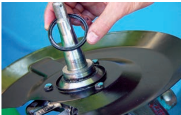
شکل ۳-۹۵- خارج کردن کاسه نمد پشت توپی چرخ
