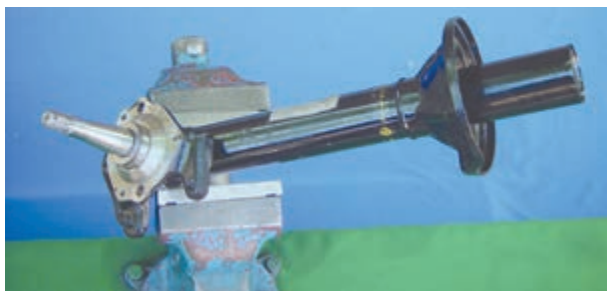
شکل ۳-۹۷- پوسته کمک فنر و محور چرخ
