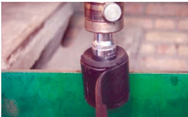
شکل ۳-۶۹- بوش لاستیکی فلزی محل اتصال شاه فنر
