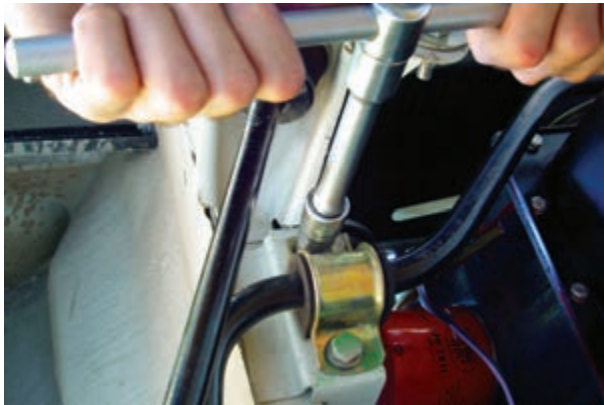
شکل ۳-۸۶- باز کردن میله ضد غلتش (موج گیر)
