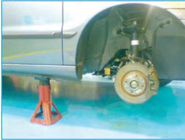
شکل ۳-۶۱- خودروی مستقر بر پایه قابل تنظیم
