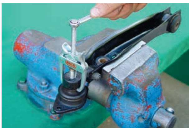
شکل ۳-۸۵- جدا کردن سیبک از بازوی اتصال
