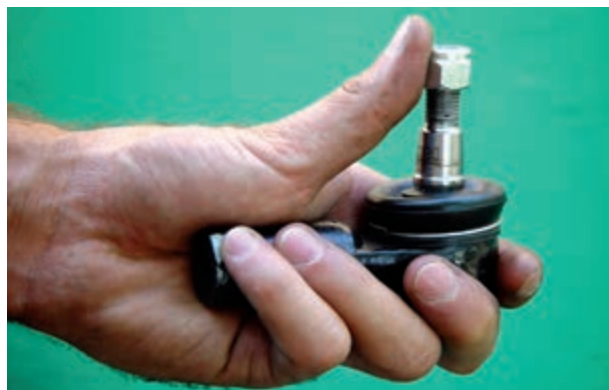
شکل ۸۴-۲- کنترل لقی سیبک‌ها
