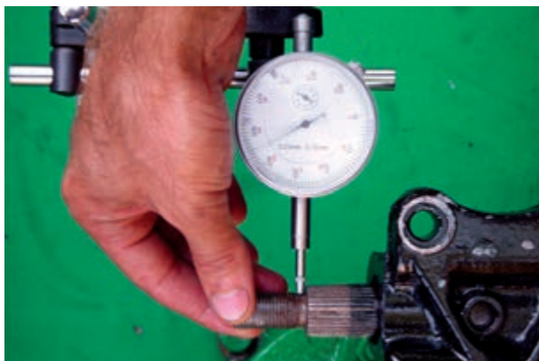
شکل ۷۱-۲- اندازه‌گیری لقی جانبی محور هزار خار
