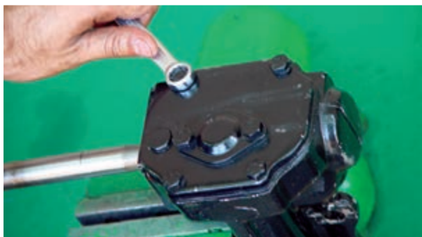
شکل ۲-۶۲- باز کردن درپوش بالایی جعبه فرمان
