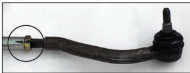
شکل ۲-۷۴- علامت گذاری سبیک و میل رابط
