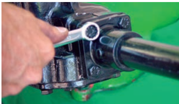
شکل ۲-۶۰- باز کردن پیچ‌های لوله فرمان
