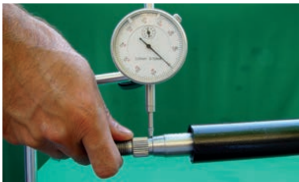
شکل ۶۹-۲- اندازه‌گیری لقی جانبی میل فرمان
