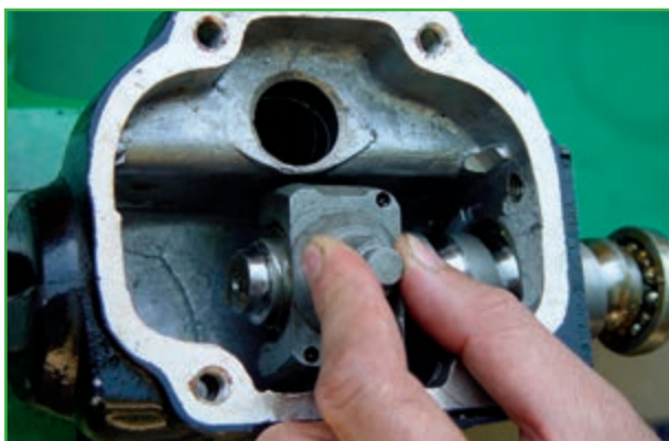
شکل ۲-۶۳- خارج کردن محفظه ساچمه‌ها
