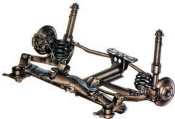
شکل ۳-۴۸- سیستم تعلیق مستقل عقب با چرخ‌های متحرک
