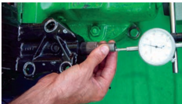
شکل ۷۰-۲- اندازه‌گیری لقی طول محور هزار خار
