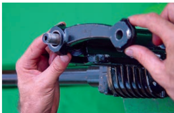
شکل ۲-۵۹- پیاده کردن اهرم هزار خار
