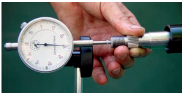
شکل ۶۸-۲- اندازه‌گیری لقی طولی میل فرمان
