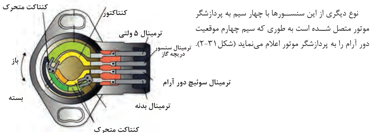
شکل ۲-۳۱- سنسور موقعیت دریچه گاز
