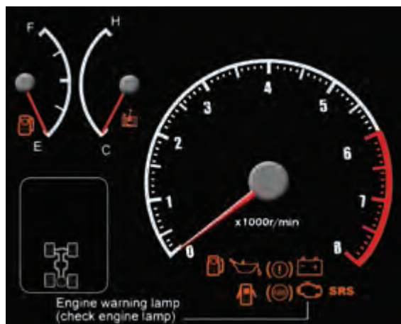
شکل ۲-۲۳- لامپ عیب‌یاب موتور
