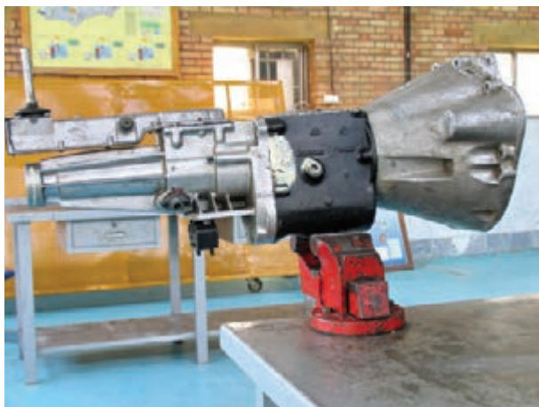
شکل ۱۶۳- جعبه دنده خودروی محرک عقب
