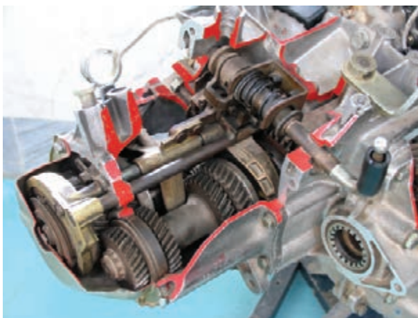
شکل ۱۶۲- جعبه دنده خودروی محرک جلو
