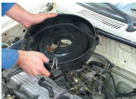
شکل ۱۰۰-۱ پیاده کردن مجموعه هواکش
