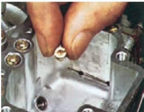
شکل ۱۱۸- ۱ باز کردن ژیکلور اصلی
