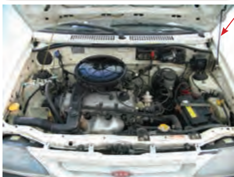
شکل ۱۱۹- ۱ نصب صحیح اهرم نگه‌دارنده درپوش موتور خودرو
