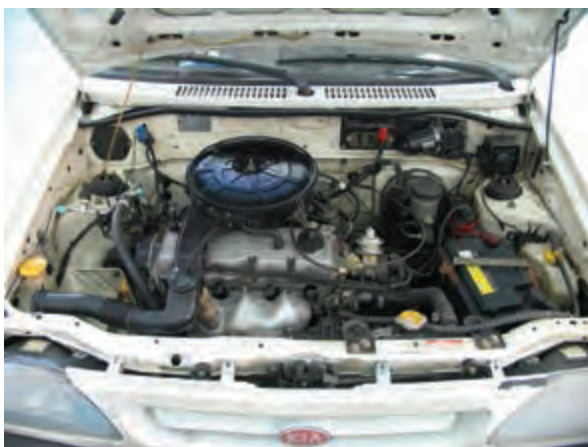
شکل ۱۱۳- ۱ موتور کاربراتورهای روی پایه
