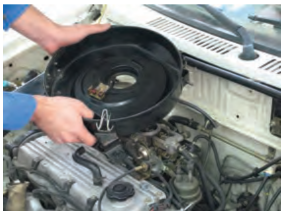
شکل ۱۱۴- ۱ پیاده کردن مجموعه هواکش
