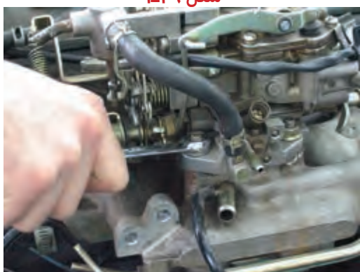
شکل ۱-۱۱۰ باز کردن پیچهای اتصال کاربراتور به موتور
