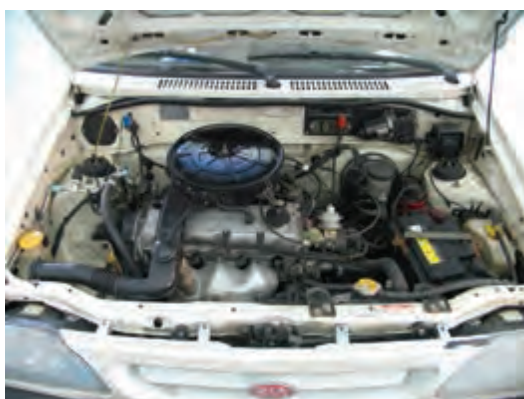
شکل ۹۹-۱ خودرو با سیستم سوخت‌رسانی کاربراتوری
