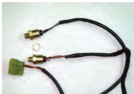
شکل ۱-۹۱ اجزای الکتریکی در یک نوع کاربراتور
