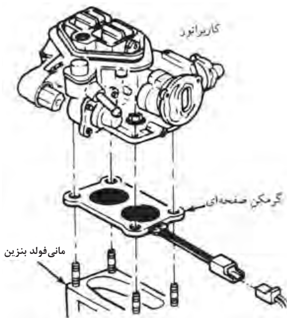
شکل ۹۴-۱ گر مکن صفحه‌ای کاربراتور
