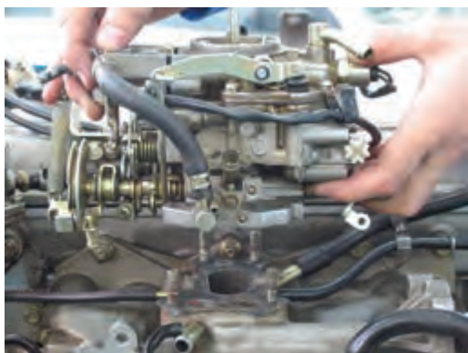
شکل ۱-۱۱۱ پیاده کردن کاربراتور
