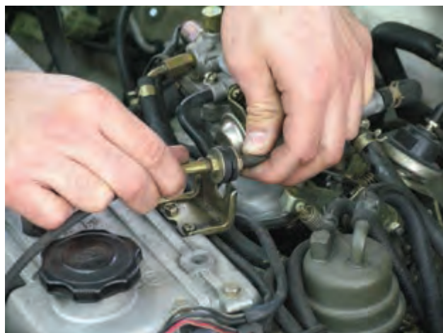
شکل ۱۱۵-۱ پیاده کردن کاربراتور
