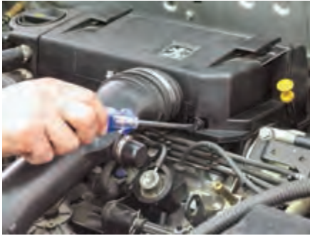
شکل (۲-۶۵) نصب در پوش محافظه فیلتر هوا
