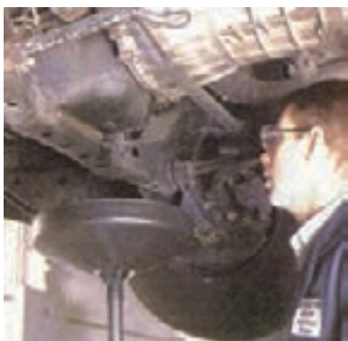
شکل (۲-۵۵) کنترل تخلیه شدن کامل روغن
