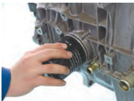
شکل (۲-۵۴) نصب و محکم کردن فیلتر
