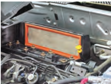
شکل (۲-۶۲) فیلتر سیستم هوارسانی
