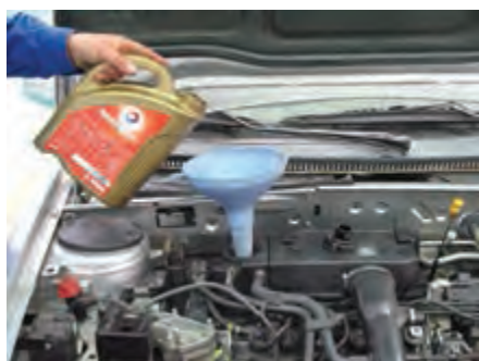
شکل (۲-۵۸) شارژ با روغن توصیه شده
