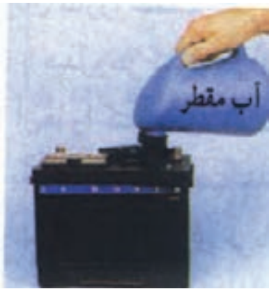
شکل (۲-۸۹) اضافه کردن مایع باتری
