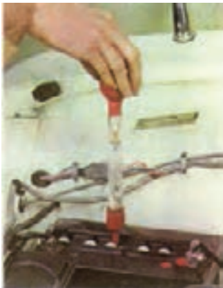
شکل (۲-۸۸) اندازه گیری غلظت مایع باتری
