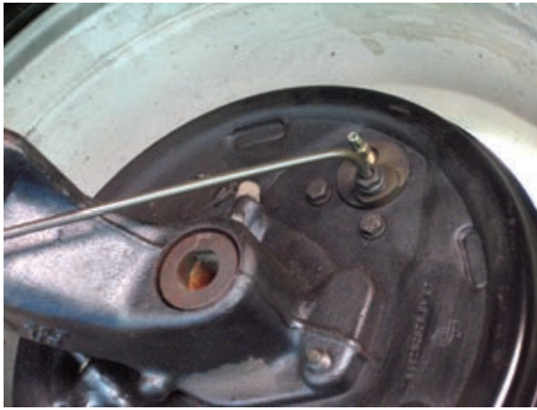
شکل ۱۰۳-۱- پاک کردن اطراف اتصالات
