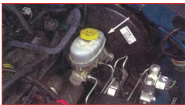
شکل ۱-۷۸- مخزن مایع ترمز و پمپ اصلی
