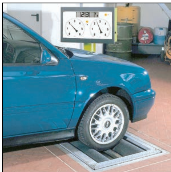
شکل ۱-۷۴ – دستگاه آزمایش دینامیکی ترمز
