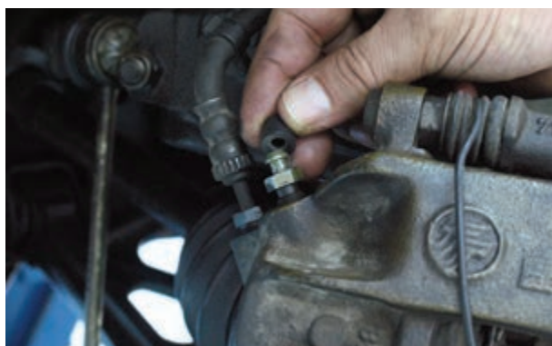
شکل ۱-۷۰- پاک کردن اطراف پیچ هواگیری
