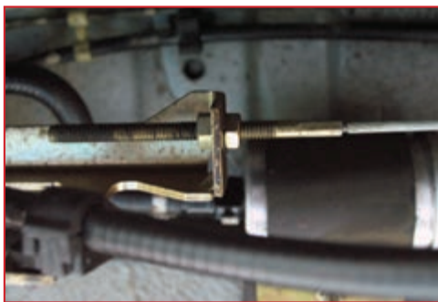
شکل ۴۸-۱- باز کردن مهره تنظیم کننده
