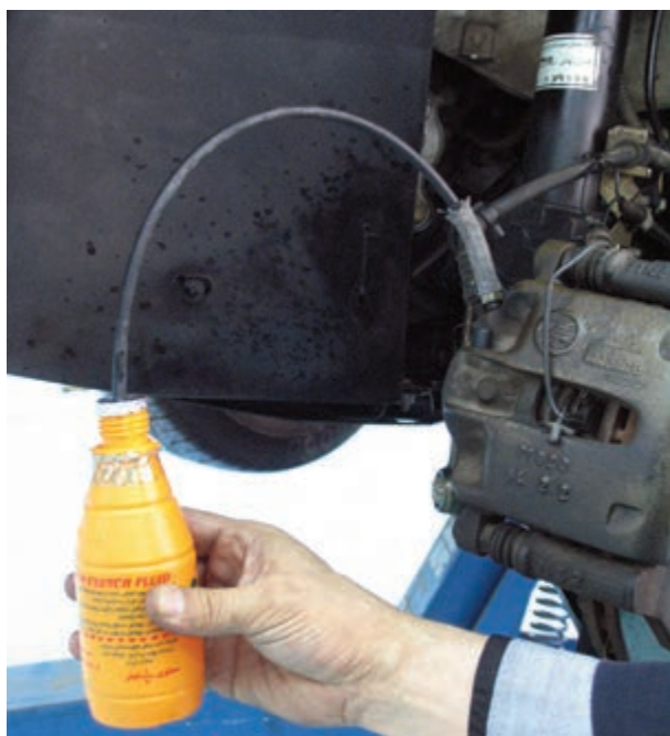
شکل ۱-۷۱- نصب لوله پلاستیکی روی پیچ هواگیری
