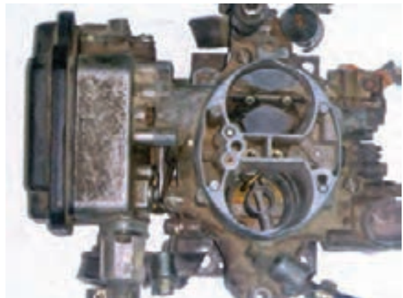
شکل ۱-۸۰ دریچه ساسات در کاربراتور دودهانه با راه‌اندازی بی‌متال
