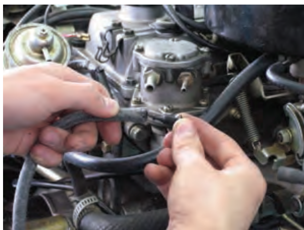
شکل ۱-۴۱ جدا کردن لوله‌ها
