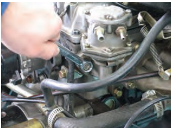
شکل ۱-۴۲ پیاده کردن پمپ
