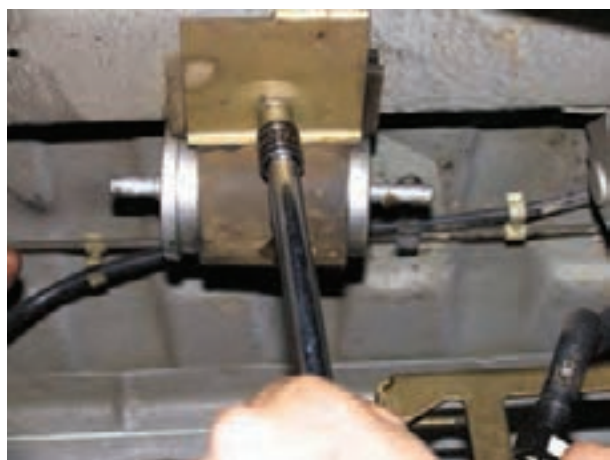
شکل ۱-۴۸ نصب فیلتر جدید
