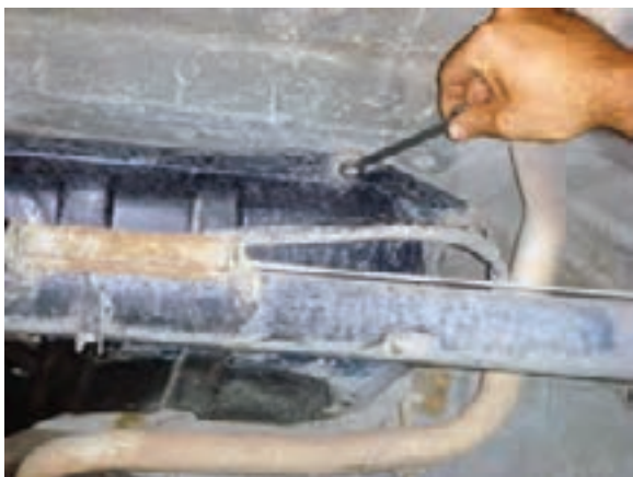
شکل ۱-۲۵ باز کردن پیچهای دور باک
