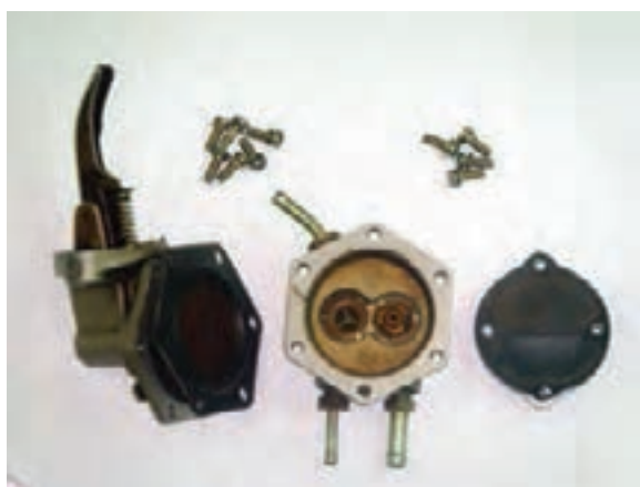
شکل ۱-۴۳ اجزای پمپ سوخت
