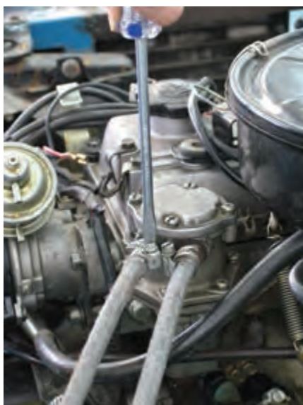
شکل ۱-۳۲ اتصال لوله سوخت به پمپ
