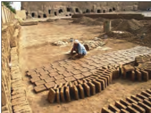
شکل ۱-۵۴ خشت خام (ساخت آجر به روش دستی)
