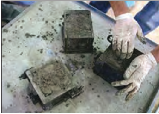
شکل ۱-۵۱ آزمایش مقاومت بتن
