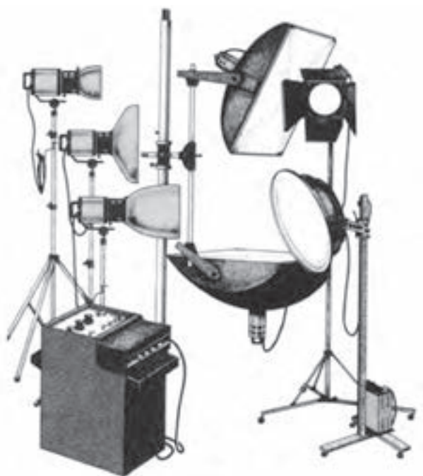
شکل ۴-۳- انواع نورافکن‌های تنگستن و فلاش‌های استودیویی
