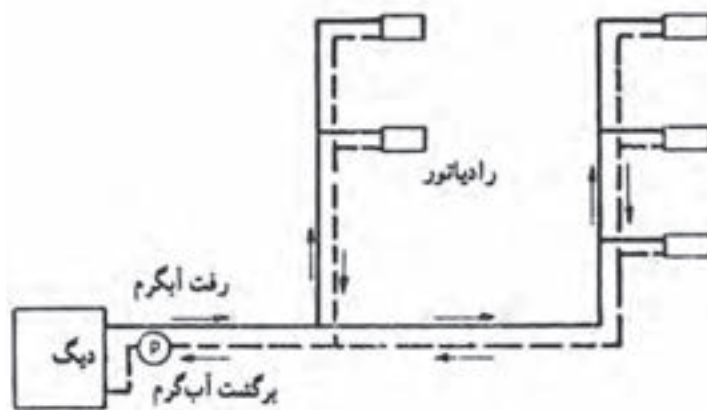
▲ شکل ۳-۹- حرارت مرکزی با آب گرم
