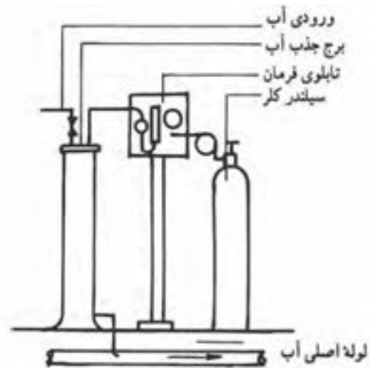
▲ شکل ۴-۶ نمای ساده دستگاه کلرزنی
