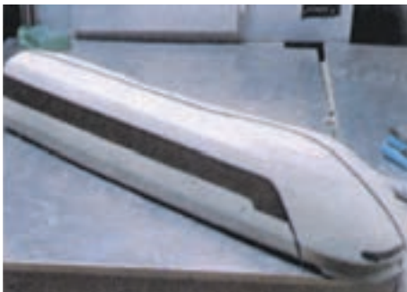
۷- با استفاده از زوار خطوط اصلی روی مدل اجرا می‌گردد.
