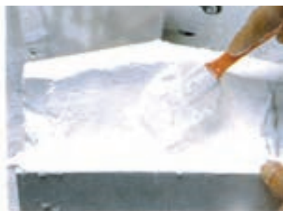
۱۶- گچ را درون قالب یک دست کنید.
