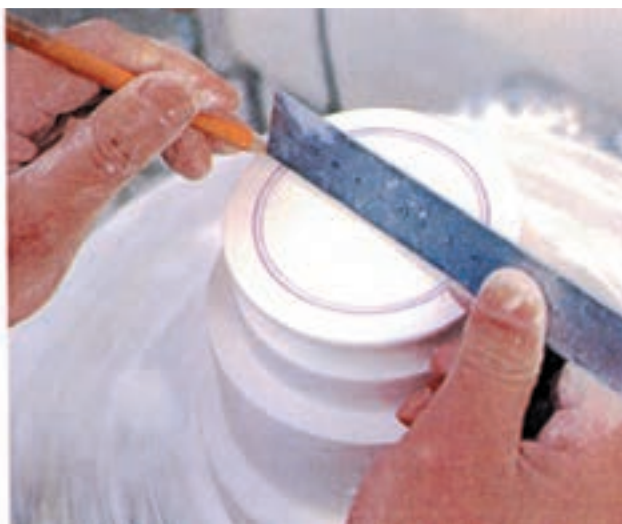
۱۳- گچ گذاری روی پایه - تراشیدن و اندازه گیری برای تراشهای بعدی
