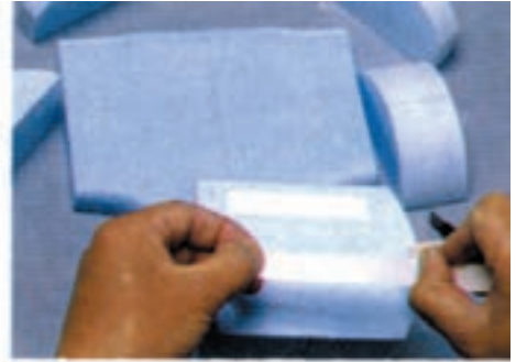
۱- برش قطعات از پیش طراحی شده از بلوفوم
