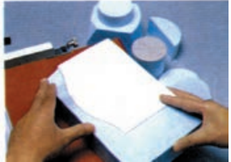
۲- مونتاز قطعات فومی ساخته شده
