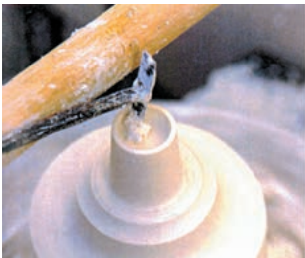
۸- تراش داخلی با استفاده از تکیه‌گاه
