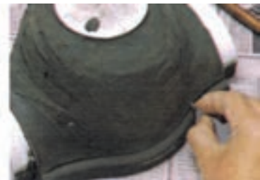
۷- از یک تیغه پلاستیکی به ضخامت یک میلیمتر به عنوان شابلون لبه گیری مدل استفاده کنید.
