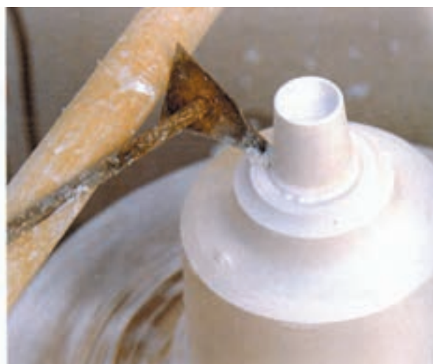
۹- مشخص کردن ارتفاع دقیق
