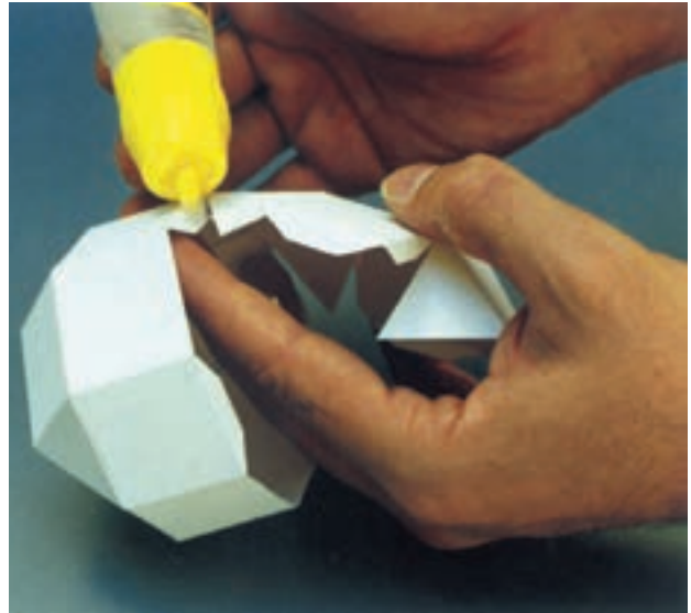
شکل ۱۸- مراحل ساختن حجم با مقوا (مراحل تکمیلی چسباندن حجم)
