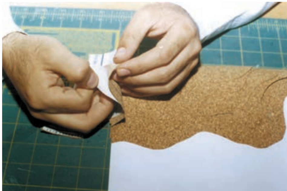
شکل ۲۴ - استفاده از ورقهای چوب پنبه در ساخت یک ماکت
