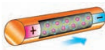
▲ شکل ۱۳-۱ حرکت الکترون‌ها
