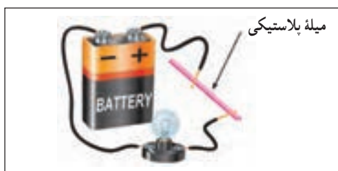
▲ شکل ۱-۱۰- میله پلاستیکی عایق است
