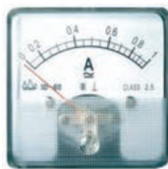
▲ شکل ۱۴-۱ آمپر متر
