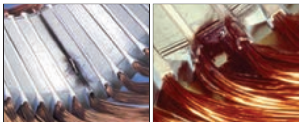
▲ شکل ۲-۲ اتصال سیم‌های حامل جریان با بدنه فلزی یک موتور الکتریکی
