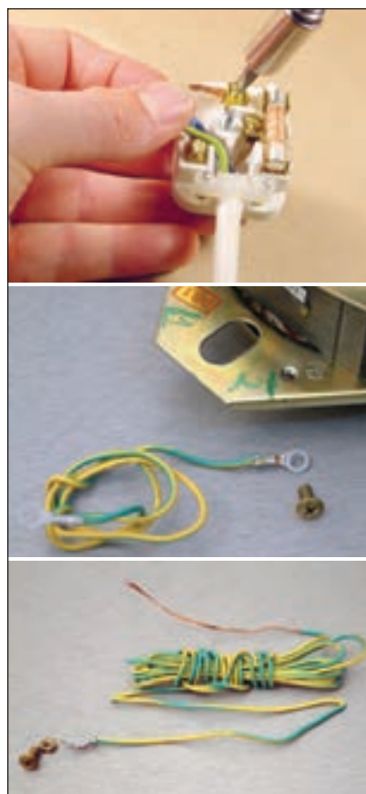
▲ شکل ۱۳-۲- اتصال سیم ارت به بدنه دستگاه‌ها و دو شاخه
