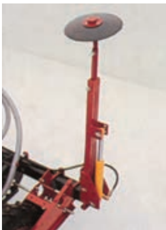
شکل ۷-۱۲- علامتگذار و جک هیدرولیکی متصل به آن
