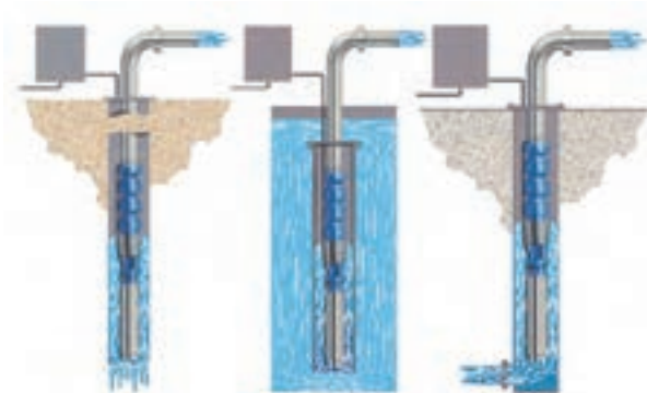
شکل ۵-۵- حالات مختلف نصب پمپ شناور
