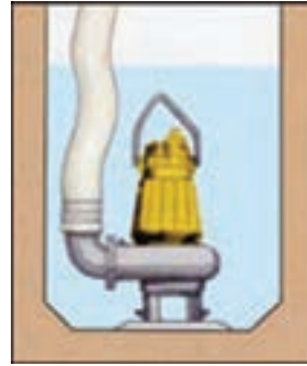
شکل ۸-۵- نصب پمپ کف کش در چاهک
