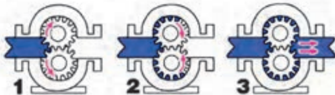
شکل ۱-۳- مراحل کار پمپ دنده خارجی
