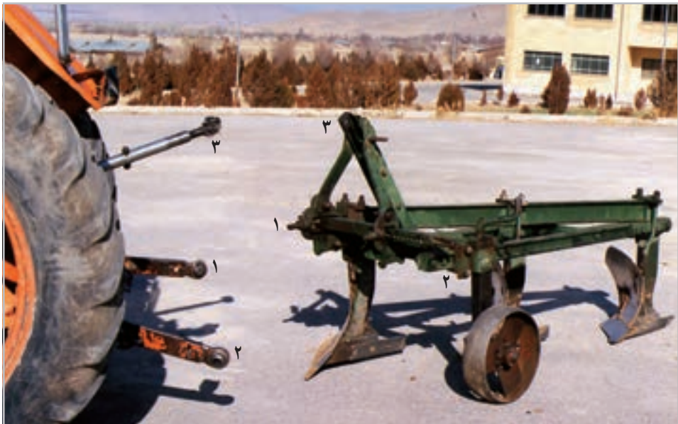
شکل ۲۰-۱- نقاط سه‌گانه اتصال گاوآهن و تراکتور
