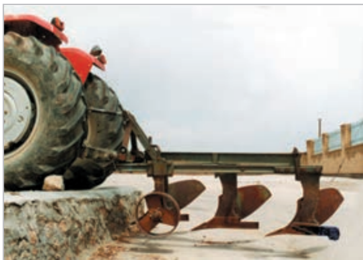
شکل ۲۶-۱- نحوه تنظیم عمق کار گاوآهن
