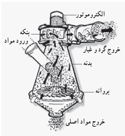
شکل ۲-۷- طرح کلی تمیزکننده گردبادی
