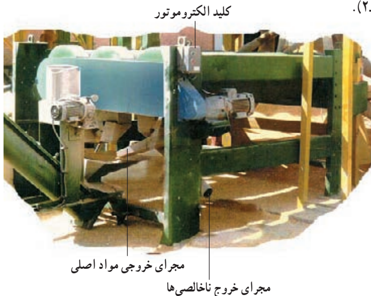
شکل ۱۲-۲ دستگاه بوجاری استوانه حفره‌دار در حال کار
