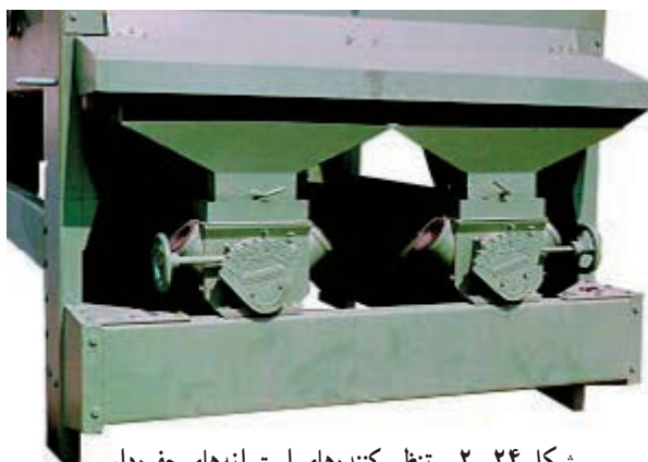
شکل ۲۴-۲- تنظیم‌کننده‌های استوانه‌های حفره‌دار
