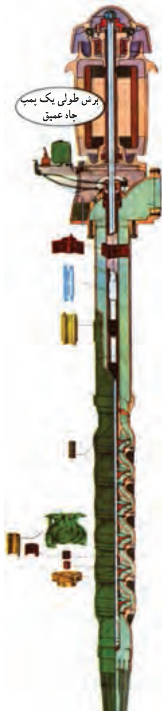
شکل ۱۹-۷-الف - پمپ توربینی چند طبقه عمودی
