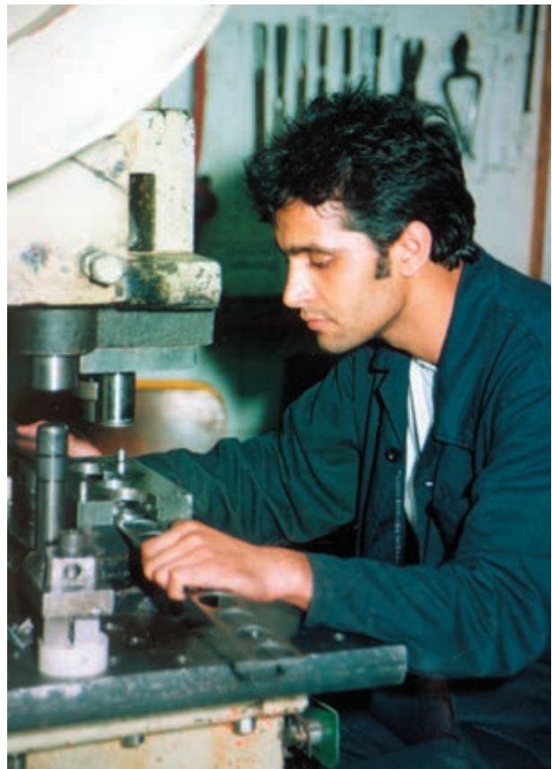
شکل ۳-۶- نمونه ای از شرایط نایمن - دستگاه پرس حفاظی برای جلوگیری از ورود دست به منطقه خطرناک ندارد.
