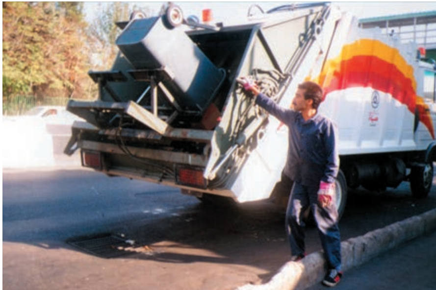
شکل ۱۱-۲- نمونه یک ماشین جمع‌آوری زباله و تخلیه اتوماتیک زباله به داخل آن
