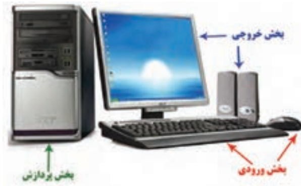
شکل ۱-۲- بخش‌های مختلف سیستم رایانه‌ای
