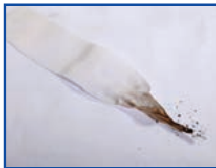
شکل ۹-۴ خاکستر حاصل از سوختن پارچه استات
