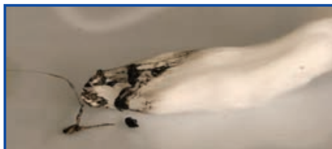
شکل ۵-۱۴- خاکستر حاصل از سوختن الیاف اکریلیک
