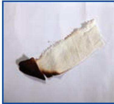
شکل ۴-۴ باقی مانده حاصل از سوختن پارچه ویسکوز ریون
