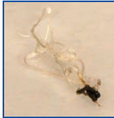
شکل ۵-۳- خاکستر حاصل از سوختن نخ نایلونی
