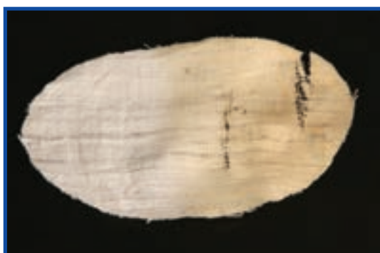
شکل ۲-۶- تجزیه پارچه پنبه ای در دمای 150^{\circ} درجه سانتی گراد
