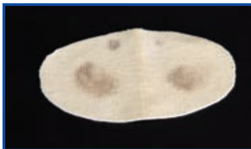
شکل ۲-۱۷- رشد قارچ و کپک در سطح پارچه پنبه‌ای
