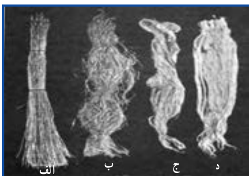
شکل ۱۹-۲ مراحل استخراج الیاف کتان از ساقه گیاه
