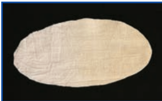
شکل ۲-۵- زرد شدن پارچه پنبه ای در دمای 120^{\circ} درجه سانتی گراد
