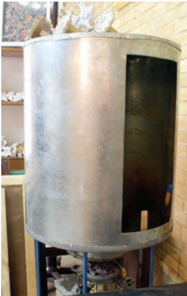
شکل ۹-۱۵- ب - منبع حرارتی و مخزن روغن کلاقه‌ای
