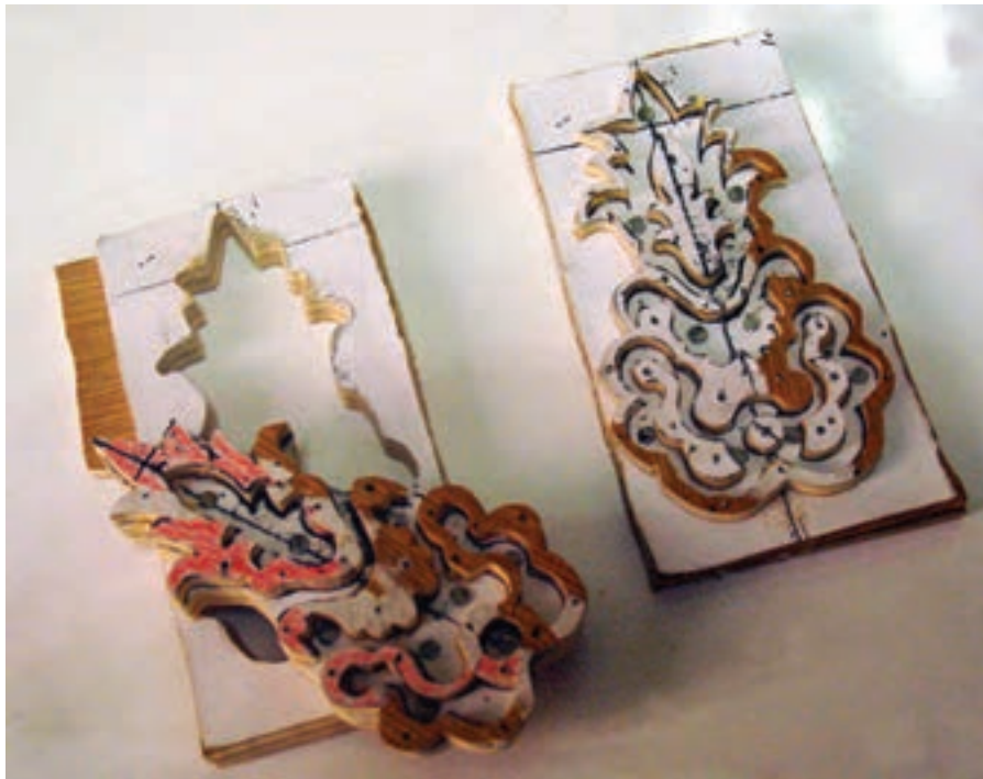
شکل ۱۸-۹- الف - آماده کردن قالب، بریدن تخته سه لایی بر اساس طرح و برجسته کردن آن
