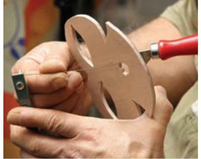
شکل ۲۰-۸-ب - برش قالب به قطعات کوچک تر
