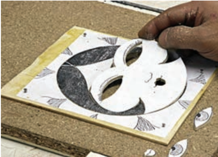
شکل ۲۰-۸-ب - برش قالب به قطعات کوچک تر
