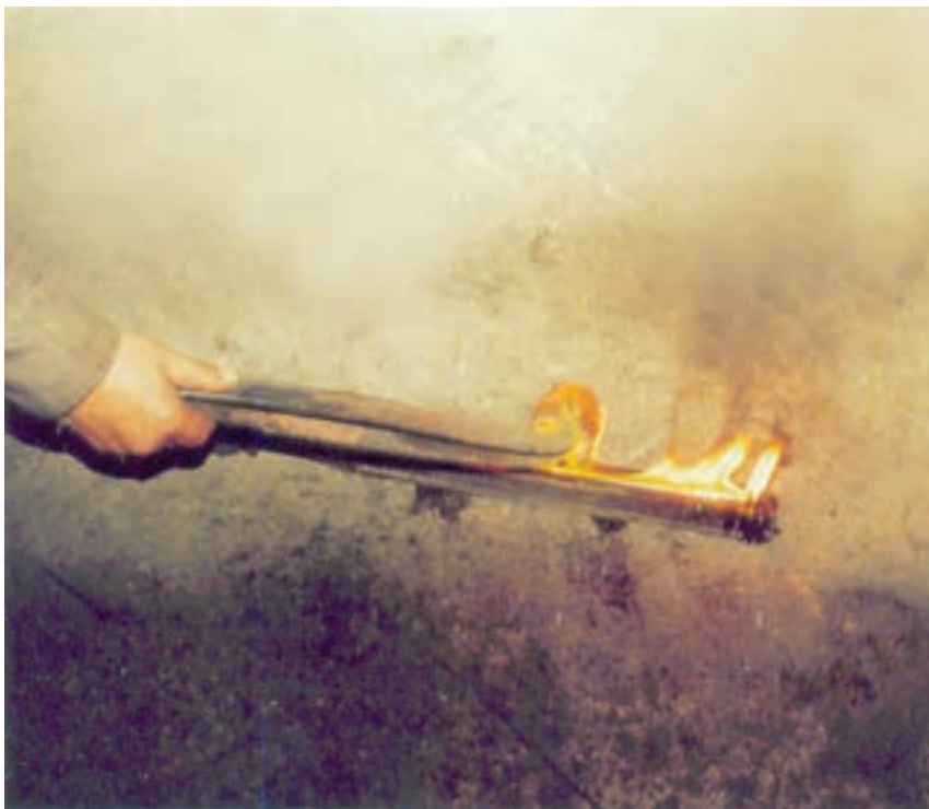
شکل ۱۱-۶- الف- تهیه‌ی مذاب نقره
