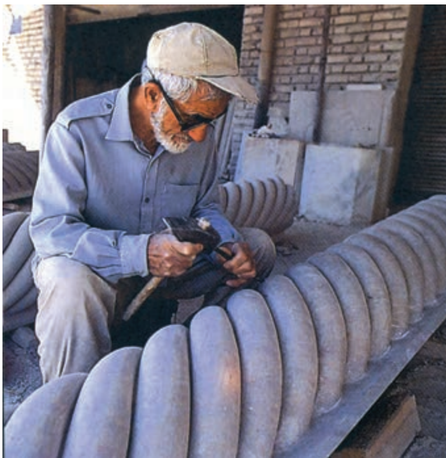
شکل ۱۱-۳- نقش برجسته کاری سنگ با قلم و چکش
