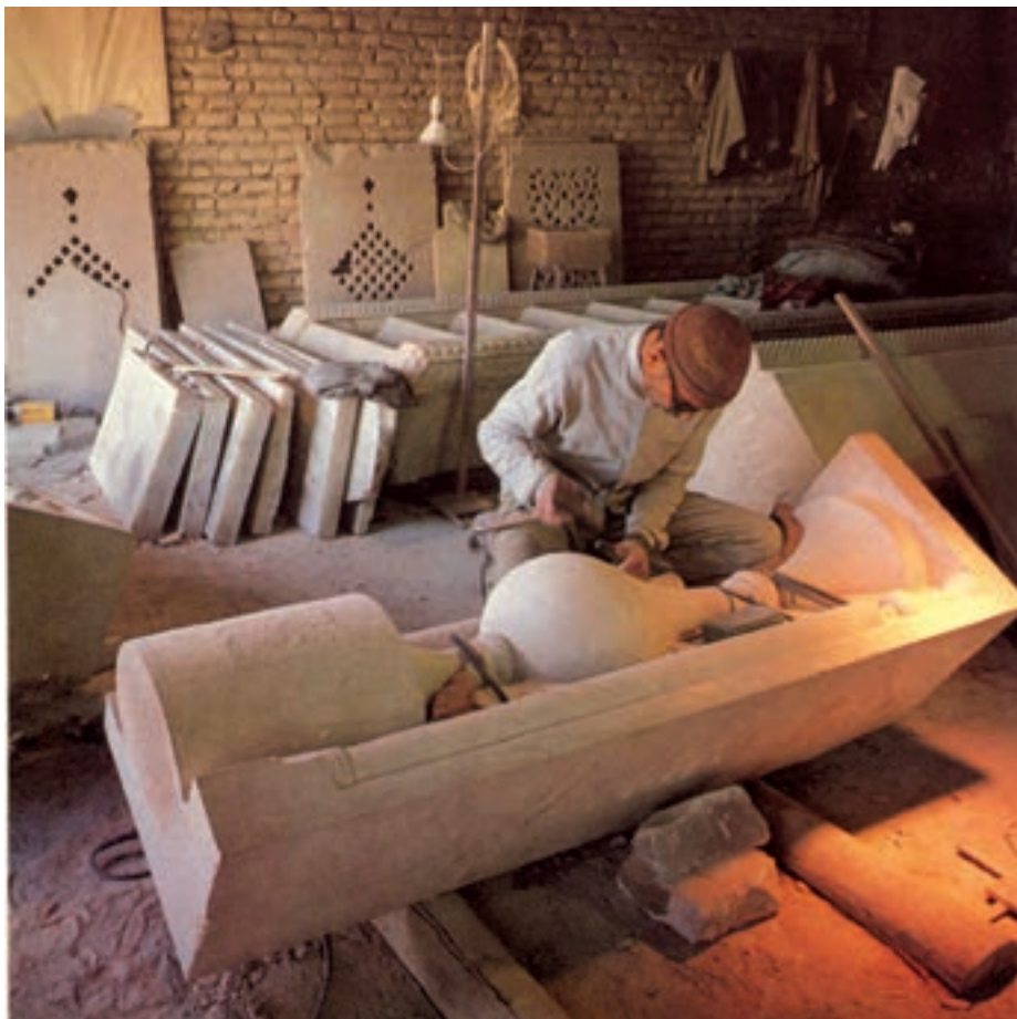
شکل ۹-۳- تراش سطح بیرونی شیء سنگی با ابزار و چرخ خراطی
