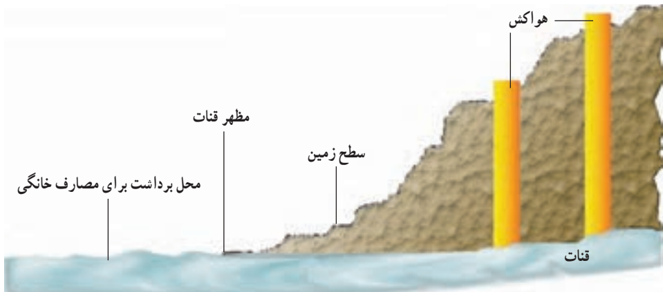
شکل ۲-۹- نحوه استفاده از آب قنات پس از ظاهر شدن
