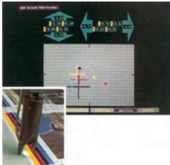
شکل ۵۱-۶— ذره بین ویدئویی با واحد روشنایی و نمایشگر موقعیت علائم انطباق
