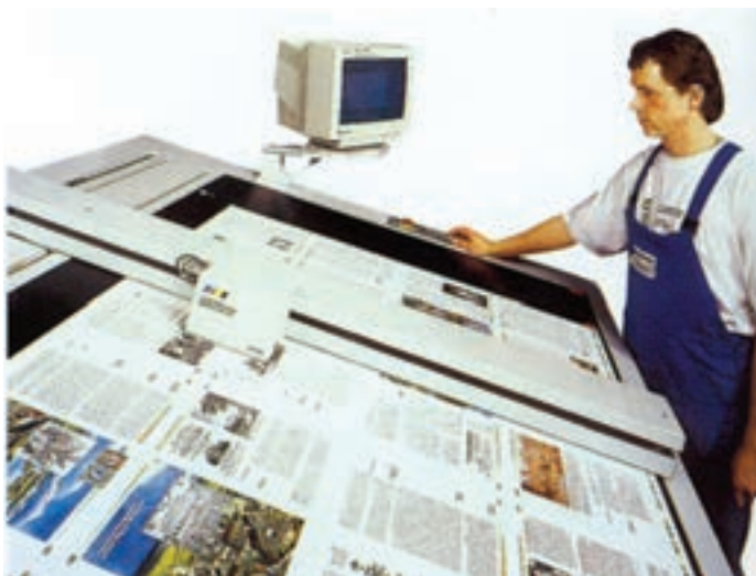
شکل ۴۰-۶- اسکن دوبعدی ورق چاپی (دنسیترونیک)
