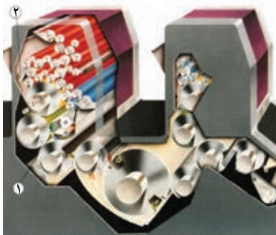
شکل ۲-۶- سیستم‌های شست‌وشوی اتوماتیک. ۱- سیلندرها ۲- نوردها
