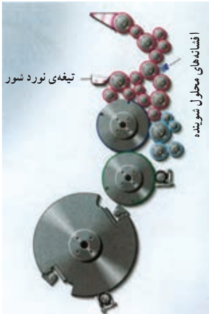
شکل ۶-۷ سیستم شست‌وشوی اتوماتیک نوردهای مرکب
