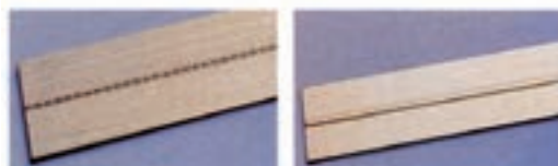
شکل ۷-۵- ورق‌های فلزی پرفراژی، قابل نصب روی سیلندر لاستیک با نوارهای خط‌زنی و پرفراژ که روی ورق چسبانده می‌شوند.
