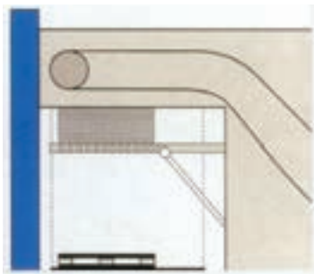
ب - غلتک ها مانند تخته تحویل به تدریج در اثر پُر شدن پالت پایین می آید.
